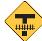
Cruce ferroviario antes de la intersección en forma de "T"
