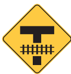
Ferrovias antes do cruzamento em "T"
